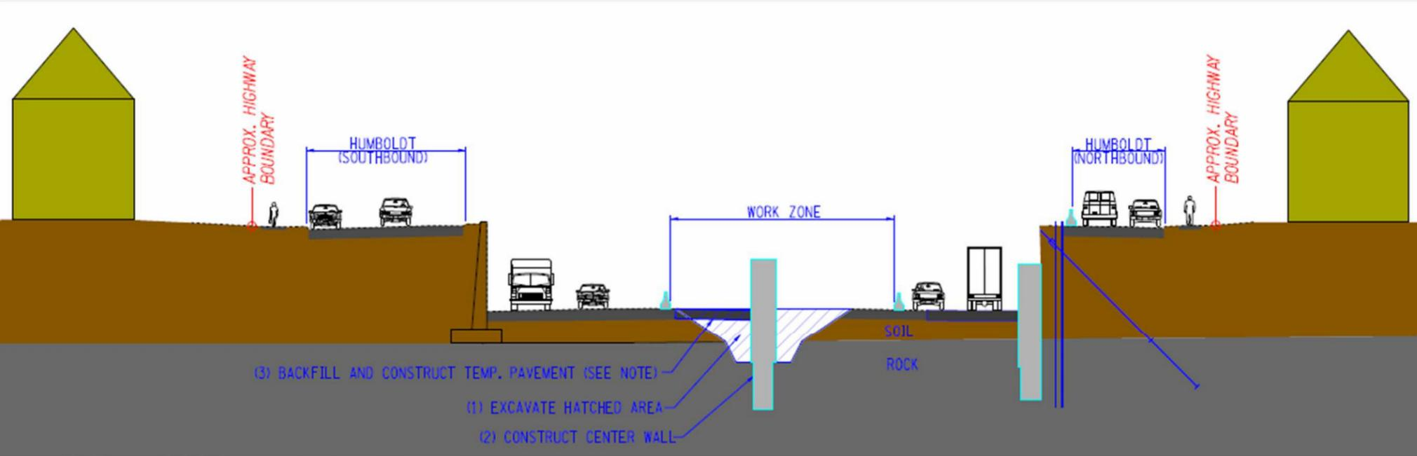
NOTE: TEMP. PAVEMENT IS REQUIRED FOR STAGE 4 TRAFFIC
