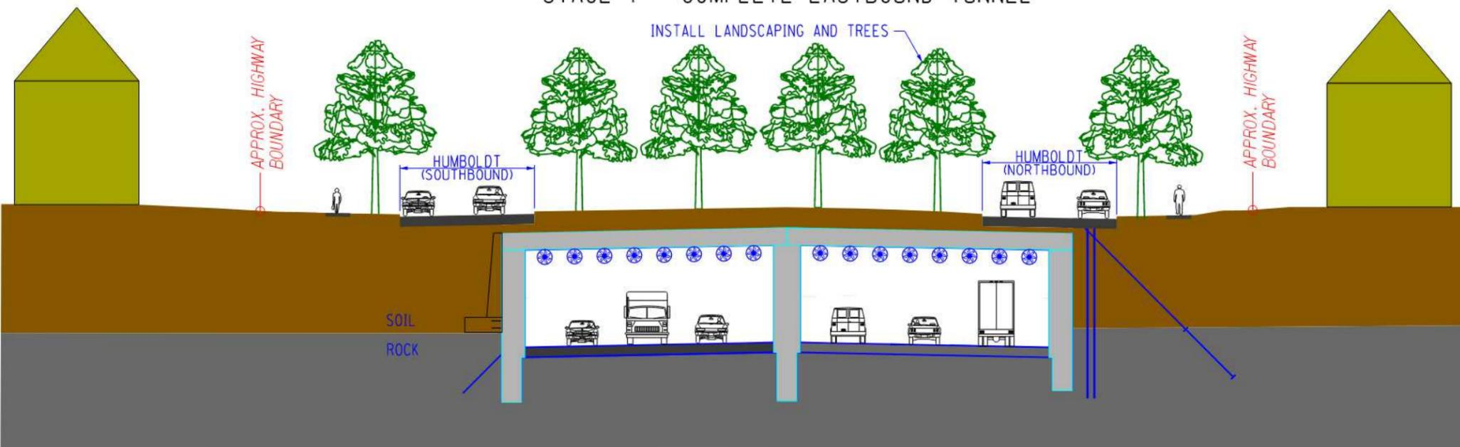
STAGE 8 - COMPLETE TUNNEL CONSTRUCTION
